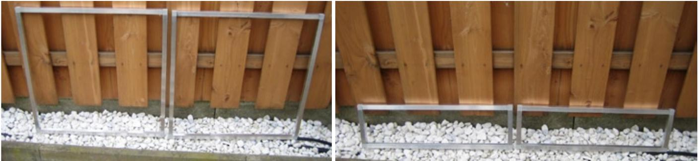
Zuerst haben wir mit den Türen und Klappen begonnen die keine Drehtablets oder zusätzliche Streben beinhalten. Die sind genau richtig zum Üben. Beim Einschlagen der Verbindungen darauf achten, dass man nur auf den Verbindungsring schlägt, das Aluminium würde das nicht verzeihen. Für das Einschlagen haben wir einen Holzhammer verwendet. Ein Gummihammer würde färben und ein Schlosserhammer haut alles breit. Als Unterlage haben wir ein Kantholz verwendet.
