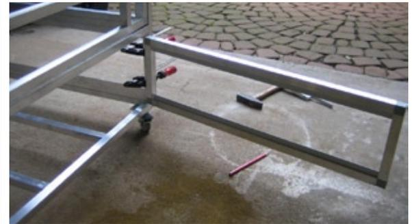
Die unteren Türen, die sich vor den Kotschalen befinden, werden jetzt mit Plexiglas versehen. Zur Befestigung der Scheiben haben wir 16mm Winkel in den Rahmen der Tür befestigt. Der Winkel soll die Kante der Kotschale überdecken. Hiervon versprechen wir uns, dass der Dreck, der von oben kommt, nicht an der Kotschale vorbei fällt.
