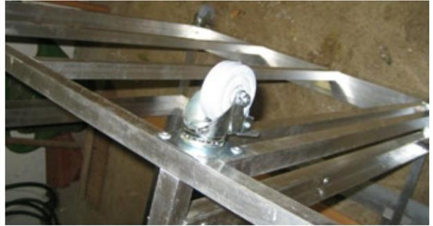
Jetzt wird es aber mal Zeit, dass sie auch zu rangieren geht. Wir haben uns für 6 Rollen, die für Holzböden geeignet sind, entschieden. Die Rollen haben einen Durchmesser von 50mm und eine Bauhöhe von 70mm. Da die Rollen eine Steckachse (falls mal eine kaputt geht, kann man diese dann leichter austauschen) haben, konnten wir die Fußplatten ruhig mit Popnieten am Grundgestell befestigen.
