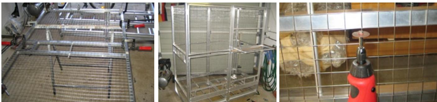
Der Draht (Edelstahl Punktschweißgitter, Masche 20x20mm) ist mittlerweile auch eingetroffen. Also das Pieke-Zeug ausgerollt und zugeschnitten. Zum Schneiden haben wir einen Minidrill mit einer Trennscheibe benutzt. Da beim Schneiden, egal ob geschnitten oder geknipst, sehr scharfe Kanten entstehen ist es sehr wichtig, die Kanten sorgfältig zu entgraten. Mein Baumeister hat hier so einige unfreiwillige Blutspenden absolviert.
