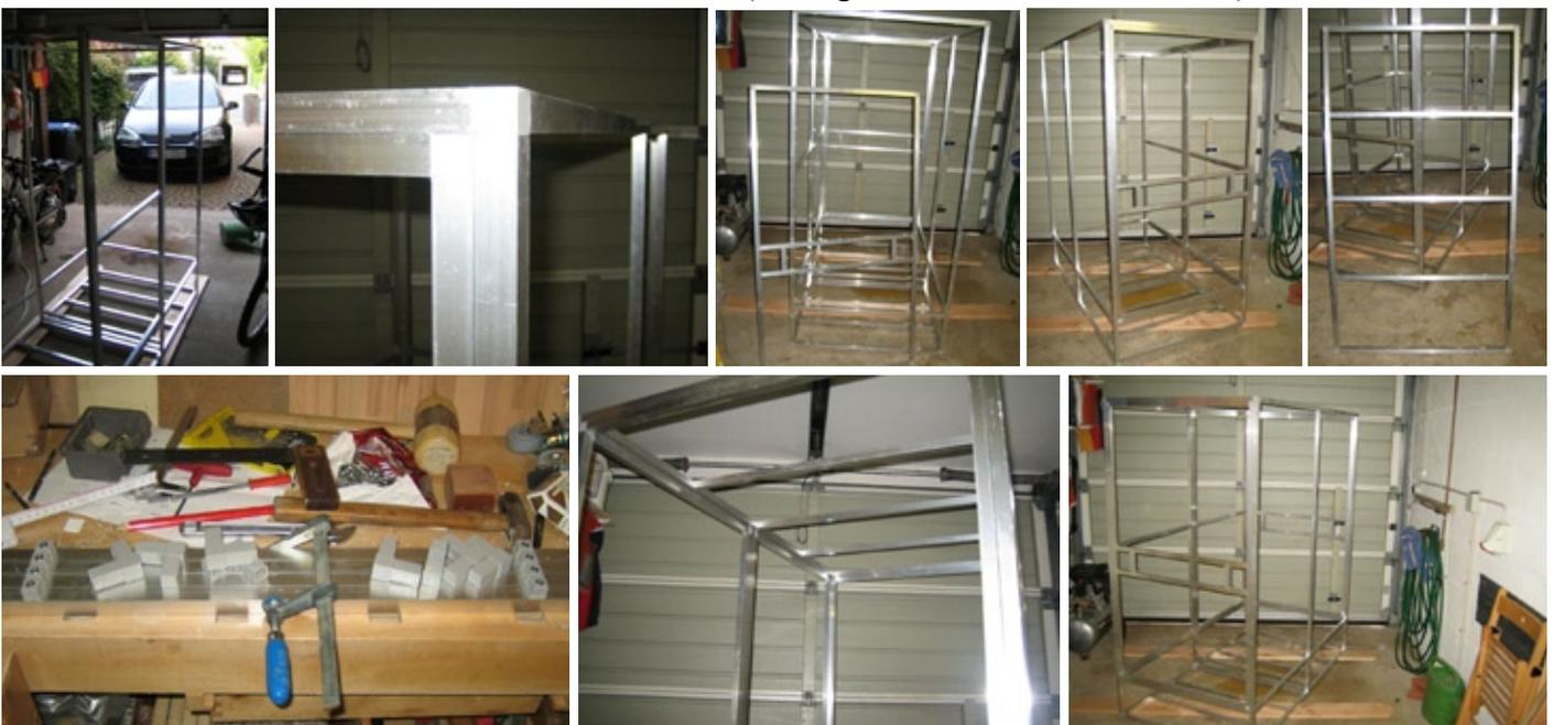
Die vorgefertigten Seitenteile und Rückwände haben wir jetzt in das fertige Grundgestell eingepasst. Das Dach noch zusammengebaut und auch eingepasst. Sieht doch schon gut aus.
