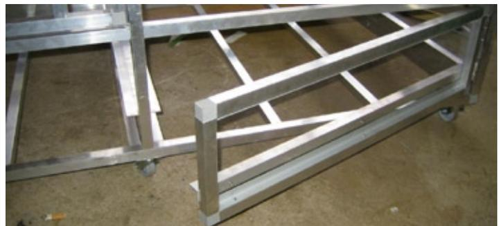
Nach dem Einbau der Plexiglasscheiben in die unteren Türen, müssen jetzt noch die Seiten links und rechts, sowie die Rückseite im unteren Bereich verglast werden. Auch hier haben wir wieder Winkel, die zur Abdeckung der Kotschalenkanten dienen, auf den Scheiben befestigt.
